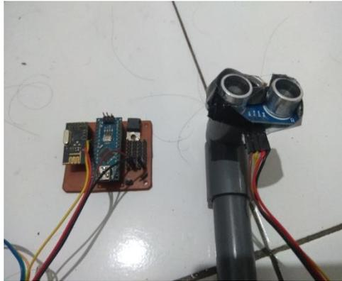
Gambar 10. penerapan rangkaian sensor 1 (sensor HC-SR04)
