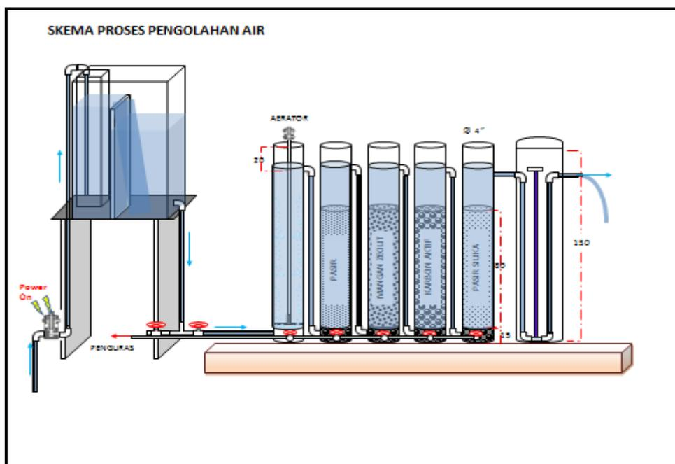
Gambar 1: Desain Rancang Bangun Alat Pengolahan Air Aerasi-Filtrasi Upflow
