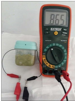
Gambar 3 Biobaterai sel galvanik dari pasta elektrolit ketapang yang menunjukkan tegangan pada rangkaian terbuka sebesar 0,865 V.
