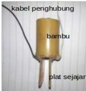
Gambar 2 Sensor kapasitif
