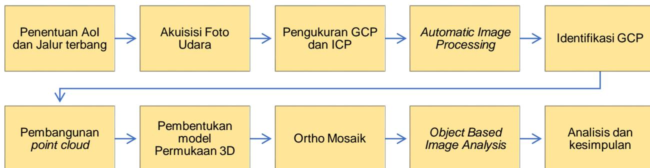
**Gambar 2.** Diagram alir pembuatan peta sawit rakyat.
