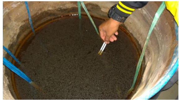
Gambar 11. Pengukuran pH air gambut setelah perendaman 3 bulan
