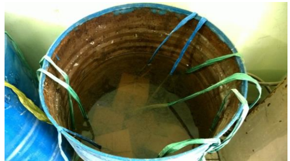
Gambar 7. Perendaman Beton pada air sungai Kahayan
