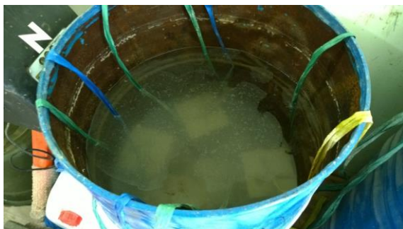
Gambar 6. Perendaman Beton pada air gambut
