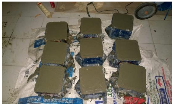
Gambar 4. Pembuatan sampel beton
