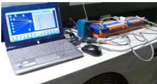
Gambar 4. Sistem instrumentasi dan data logging.
