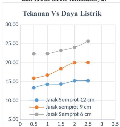
Gambar 5. Grafik hubungan tekanan (P) dengan daya listrik (P<sub>L</sub>)
