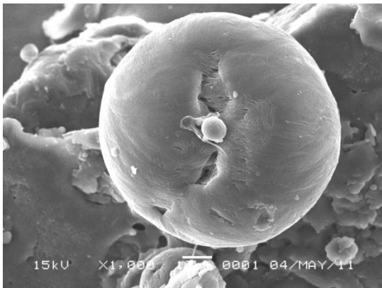
Gambar 12. Hasil SEM Dari Mikrokapsul Kosong Polikaprolakton dengan Perbesaran 1000 Kali
