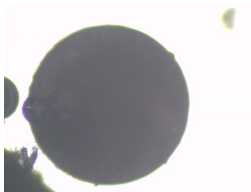
Gambar 11 Mikroskopis Mikrokapsul 2,4-Diklorofenoksi Asetat Formula-3 Perbesaran 10x
