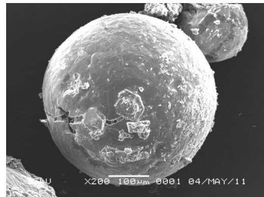
Gambar 15. Hasil SEM Mikrokapsul 2,4-Diklorofenoksi Asetat Formula-3 Dengan Perbesaran 200x
