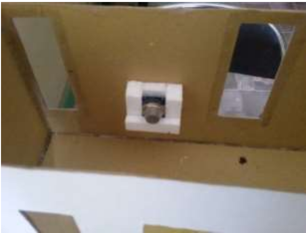
Gambar 11 Peletakan sensor asap pada ruangan
