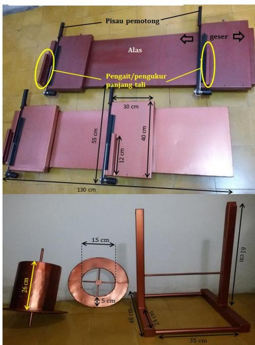
Gambar 1. Alat pemotong dan pengukur tali
