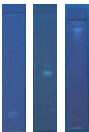
Gambar 3 Kromatogram lapis tipis isolat X, fase diam silika gel 60 GF 254 , fase gerak (a) Kloroform-metanol (96:4) (b) Kloroform-aseton-asam format (10:2:1) (c) Etil asetat-asam format-air (8:1:1)
