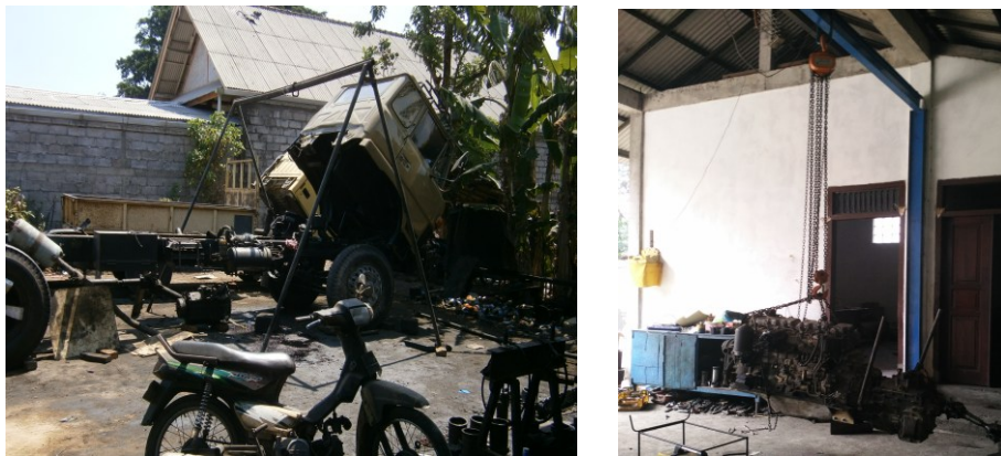
Gambar. 5. Kondisi Awal Stasiun Kerja dan sesudah penataan stasiun kerja Penggunaan katrol kapasitas 2 ton dengan 5 meter lifting
