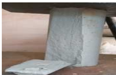
Pola keruntuhan variasi 0% Sampel 1 percobaan I
