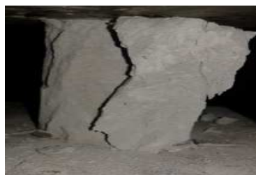
Pola keruntuhan variasi 27% Sampel 2 percobaan II
