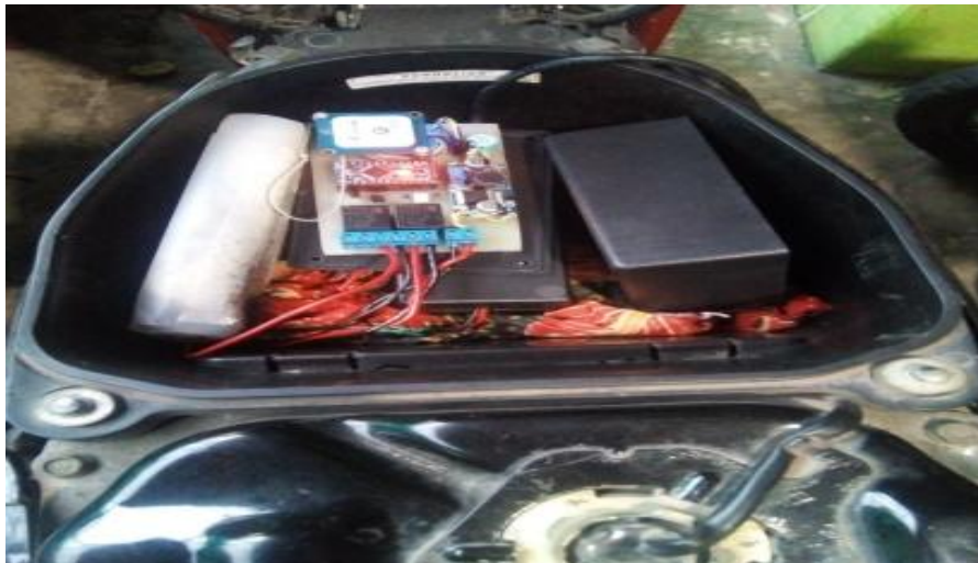
Gambar 2. Alat Pengamanan Kendaraan Bermotor yang dihubungkan dengan system kelistrikan
