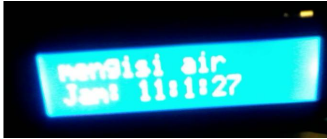
Gambar 16. Perangkat Saat Pompa Pengisi Air Aktif
