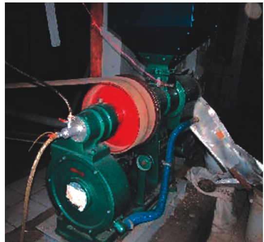
Gambar 1. Komponen alat penyosoh yang dapat digunakan dalam pembuatan beras beriodium dengan fortifikasi
