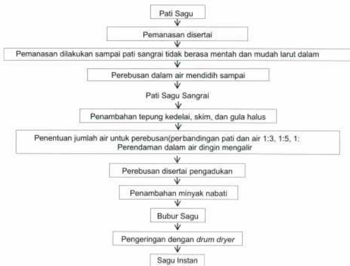
Gambar 5. Diagram Alir Proses Pembuatan Sagu Instan
