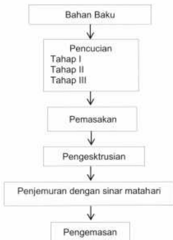
Gambar 4. Diagram Alir Proses Pembuatan Sohun Sumber : Bank Indonesia, 2007
