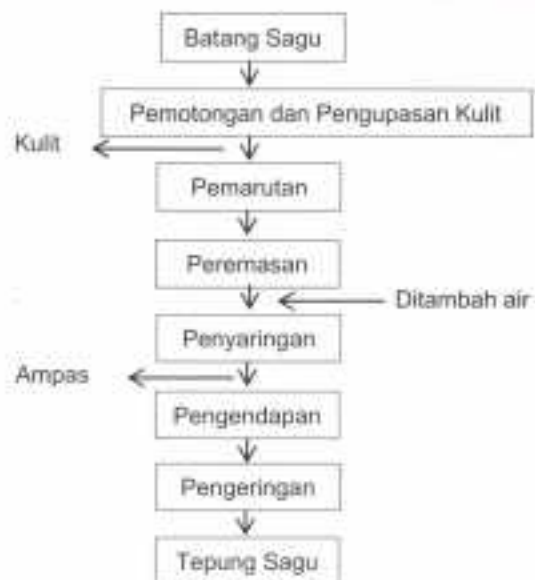
Gambar 1. Diagram alir Pembuatan Tepung Sagu
