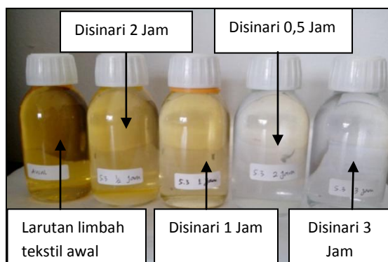
Gambar 4. Perubahan zat warna tekstil setelah ditambahkan 0,1 gram \text{TiO}_2 dan disinari sinar ultra violet selama 0,5 jam sampai 3 jam
