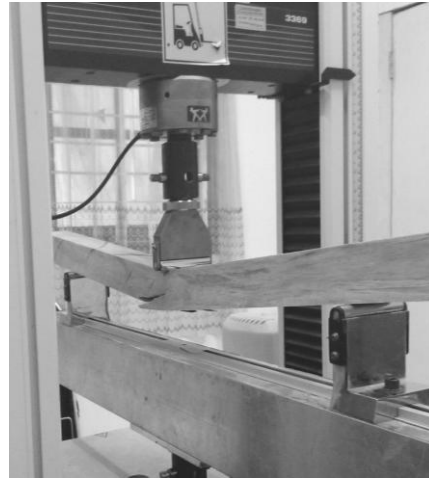
Gambar 1 Pengujian balok glulam dengan beban terpusat di tengah bentang.
