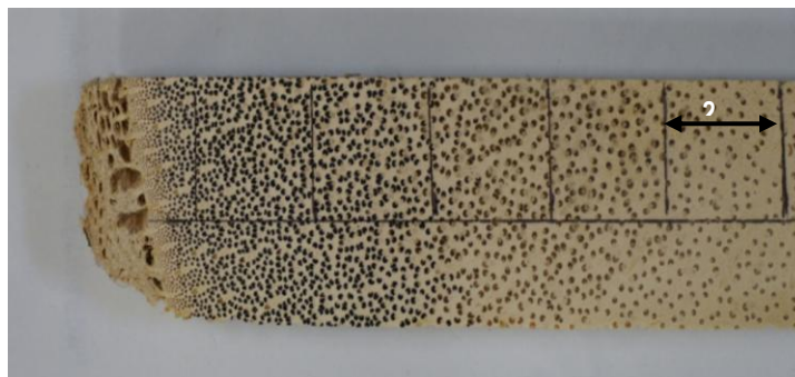
Gambar 4 Distribusi kerapatan vascular bundles batang kelapa sawit dari bagian tepi (dekat kulit) menuju ke pusat.
