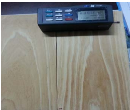
Gambar 1 Pengukuran kekasaran permukaan ( Ra ) menggunakan Roughness Tester TR200
