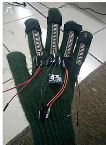
Gambar 3. Sarung tangan yang dilengkapi sensor.
