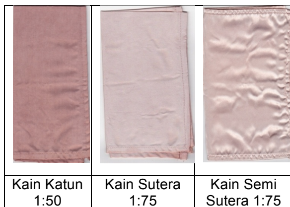
Gambar 4. Hasil pewarnaan optimum pada masing-masing jenis kain.
