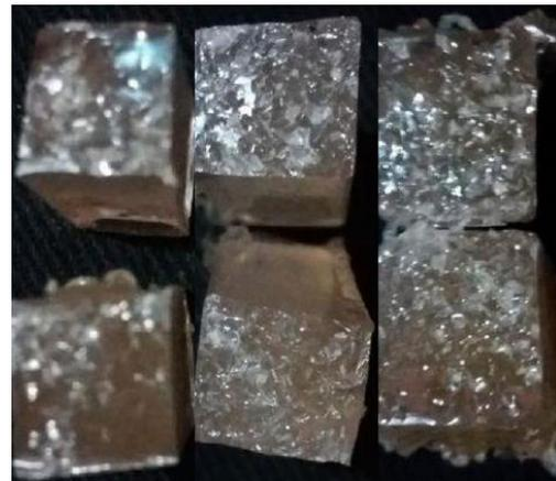
Gambar 11. Foto patahan Teflon putih
