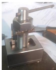
Gambar 2. Alat cetak benda uji
