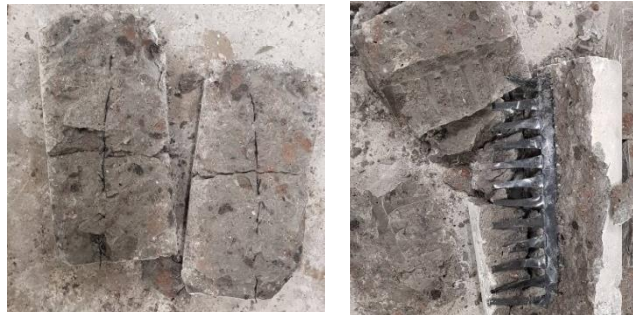
Gambar 7 Kerusakan Beton pada Saat Split Test dengan Geogrid Triaxial dan Geogrid Uniaxial
