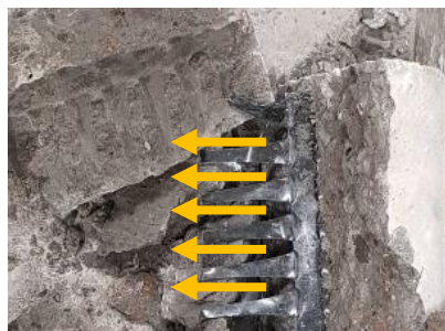
Gambar 9 Beton Terlepas dari Geogrid Uniaxial Pada Saat Split Test
