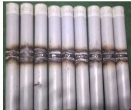
Gambar 12 Speimen setelah pengujian tarik
