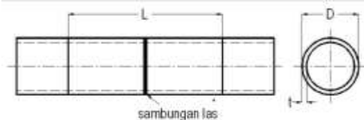
Gambar 2 Spesimen Uji Tarik Standar JIS No.14 C (JIS HANDBOOK Z2201, 1980:32)
