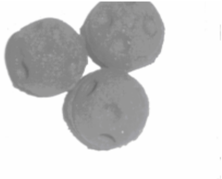
Gbr. 5. Briket promotor berbentuk bola dengan dimples
