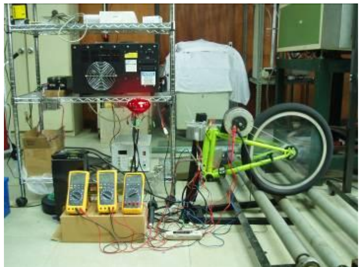
Gambar 2. Uji Sistem Fuelcell
