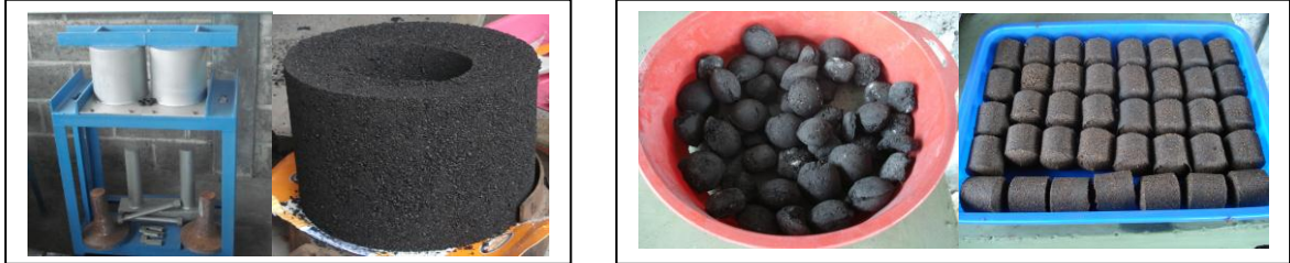
(a) (b) Gambar 6. (a) Alat Cetak Briket Bolu dan (b) Briket Bentuk Lain
