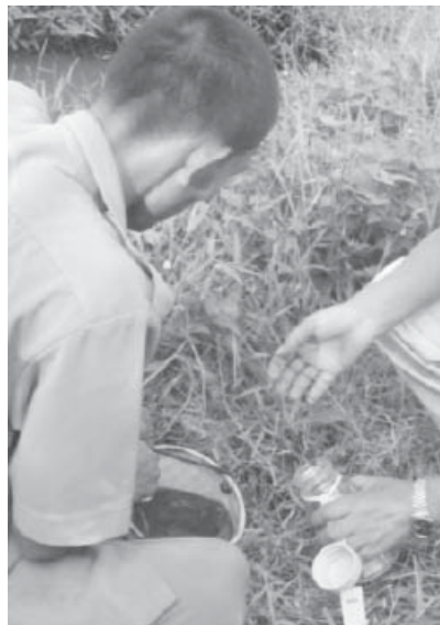
Gambar 6 Pengambilan Sample Air Limbah untuk Pengukuran COD.
