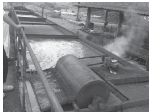
Gambar 3 (atas) saluran seb. atas adalah limbah cair dari separator dan seb. bawah dari proses perebusan, (bawah) deoiling tank
