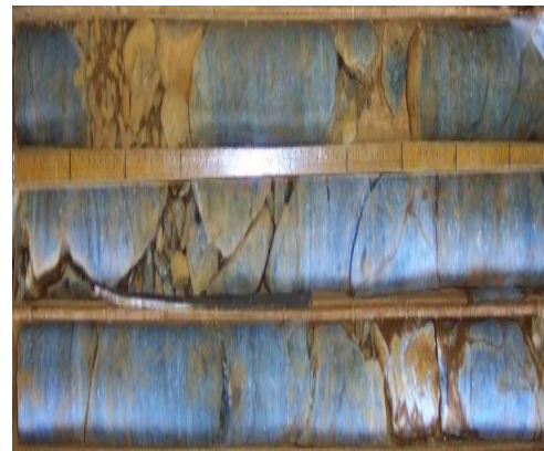
Gambar 8. Inti bor zona bedrock
