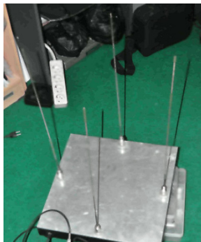
Gambar 8. Bentuk susunan antena doppler.
