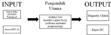
Gambar 3. Blok sistem rancangan ECU secara keseluruhan.
