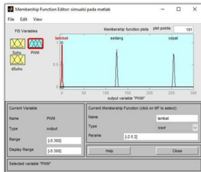
Gambar 15. Defuzzifikasi PWM kipas motor DC pada FIS editor.
