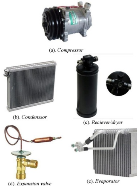
Gambar 1. Komponen utama yang ada pada sistem air conditioner pada mobil.
