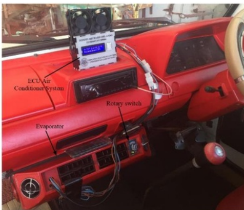
Gambar 19. Implementasi ECU air conditioner pada kendaraan mobil.
