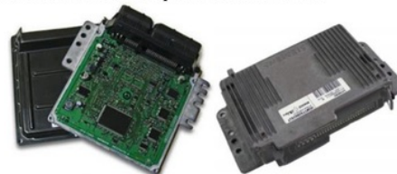
Gambar 2. Contoh Electronic control unit (ECU) pada mobil.
