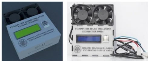
Gambar 4. Desai cover rancangan ECU.
