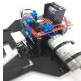
Gambar 16. Pemasangan modul driver motor
