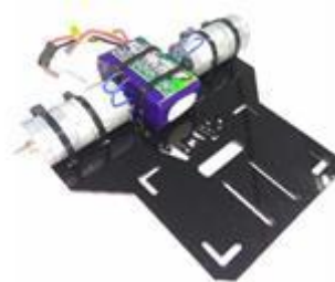
Gambar 15. Pemasangan motor dan baterai pada body robot
