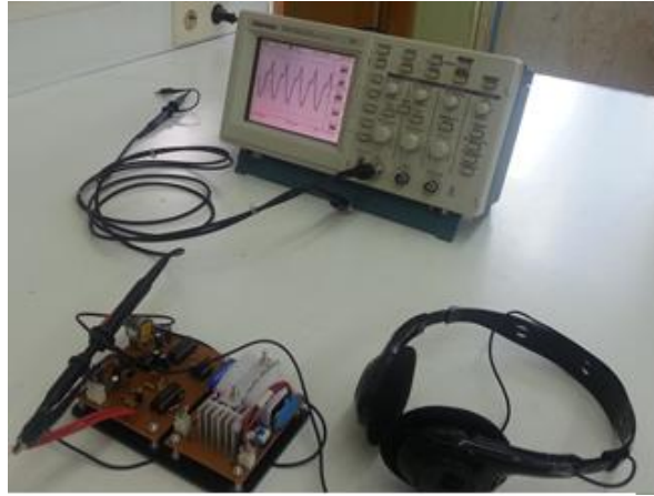
■ Gambar 17. Hasil Pengujian Modul Photo Dioda dan PLL Menggunakan Osiloskop Digital
