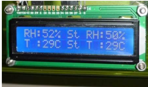
■ Gambar 7. Tampilan karakter pada LCD 16x2
