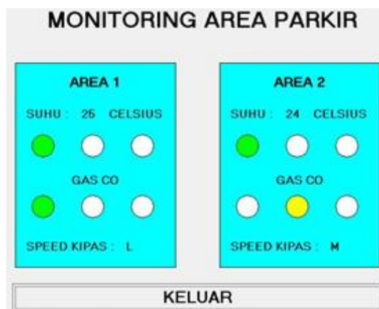
■ Gambar 13. Tampilan PC Ketika Gas CO yang Dideteksi Mencapai Tingkat Waspada
