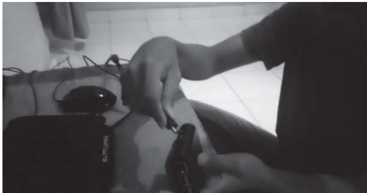
Gambar 9 Pemasangan kabel power listrik dan menghubungkan Raspberry Pi 3 ke TV LED
