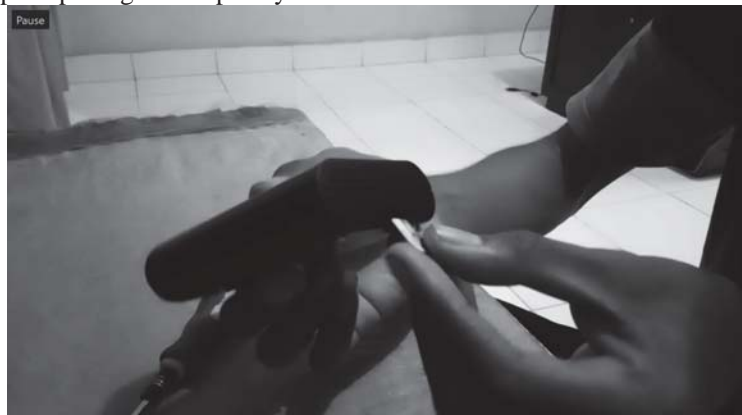
Gambar 8 Pemasangan SD Card pada Raspberry Pi 3
