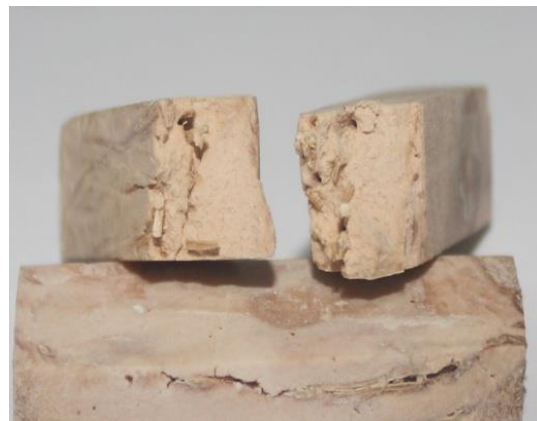
Gambar 8. Hasil patahan pada pengujian impact
