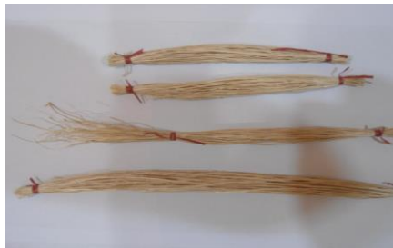
Gambar 4. Serat Umpulur Sagu setelah proses Alkalisasi
