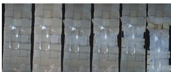
Gambar 14. Fase patahan spesimen dengan sudut 0°/90° yang memiliki kekuatan paling tinggi dengan waktu penekanan 30 s
