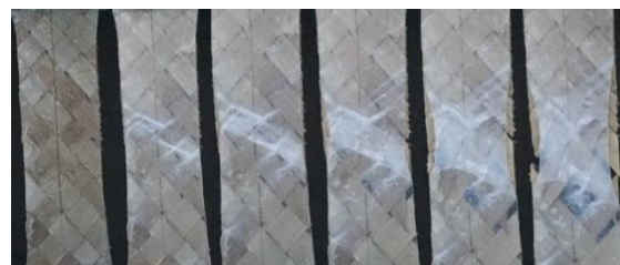
(1) (2) (3) (4) (5) (6) Gambar 11. Fase patahan spesimen dengan sudut 45°/-45° tanpa penekanan
