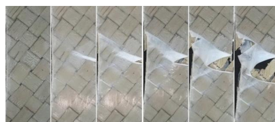
Gambar 16. Fase patahan spesimen dengan sudut 45°/-45° yang memiliki kekuatan paling tinggi dengan lama penekanan 15 s
