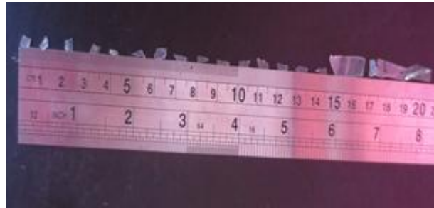
Gambar 5. Pengukuran Panjang Cacahan Sampah Plastik
