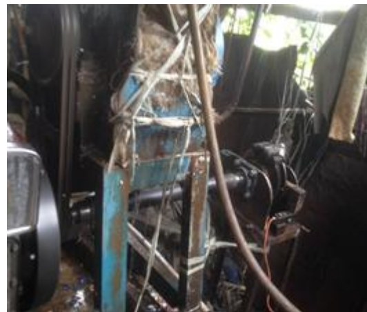
Gambar3. Pengukuran Daya Menggunakan Prony Brake Dinamometer
