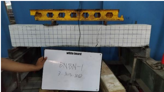
Gambar 20 Pola Retak Balok Beton Agregat Kasar Normal BNBN-1
