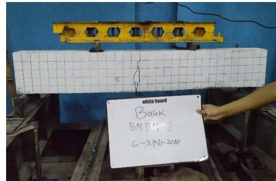
Gambar 21 Pola Retak Balok Beton Agregat Kasar Normal BNBN-2
