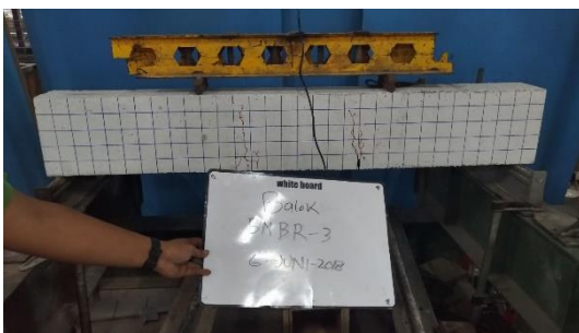
Gambar 25 Pola Retak Balok Beton Agregat Kasar Daur Ulang BNBR-3
