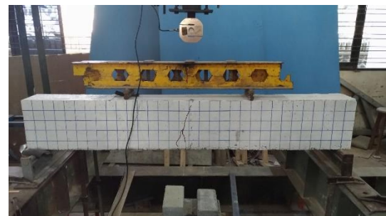
Gambar 22 Pola Retak Balok Beton Agregat Kasar Normal BNBN-3
