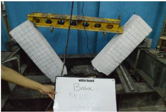
Gambar 24 Pola Retak Balok Beton Agregat Kasar Daur Ulang BNBR-2
