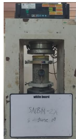
Gambar 7 Pengujian Tekan Beton
