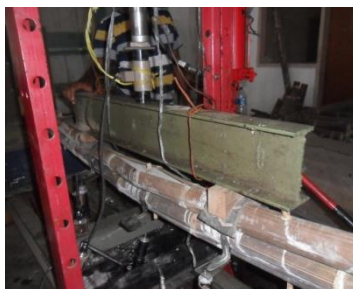
Gambar 3. Kerusakan pada benda uji balok bambu susun
