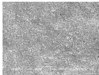
Gambar 8. Foto SEM permukaan lapisan tipis kalsium fosfat pada perbandingan molar Ca/P 1.80
