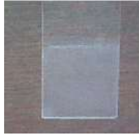
Gambar 6. Foto lapisan tipis kalsium fosfat dari Ca/P 1.80
