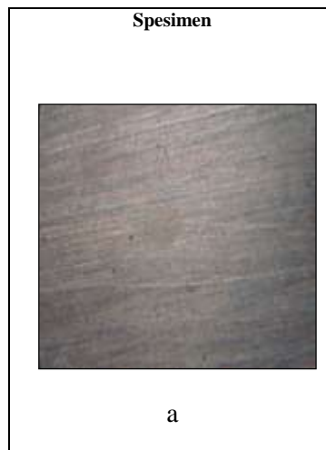
Gambar.3 Foto optik morfologi permukaan baja awal (polished) tanpa perlakuan, b dan c tanpa penambahan inhibitor
