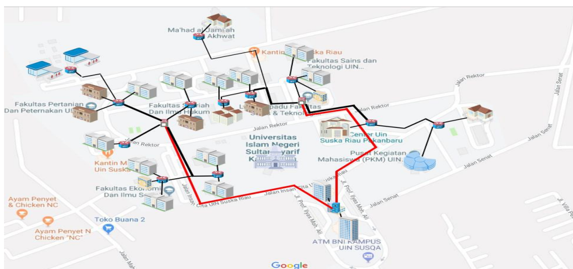
Gambar 2. Perencanaan Jaringan Optik di UIN Suska Riau dengan Arsitektur GPON
