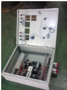
Gambar 33 Box panel hasil penempatan komponen dan pengawatan
