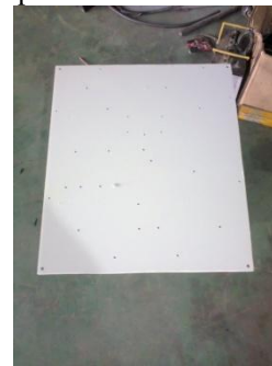
Gambar 8 Contoh hasil pemotongan plat
