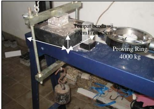
**Gambar 3.** Gambar Alat Uji Geser dan Posisi Letak Benda Uji
