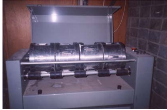
Gambar 1. Alat Micro Deval dengan 4 tabung silinder pada posisi siap dioperasikan
